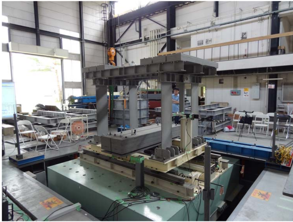
振動台実験風景 青葉山建築実験所
